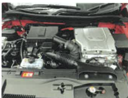
エンジンは2.4リットルで128馬力、 モーターはフロントが82馬力、リヤ が95馬力
