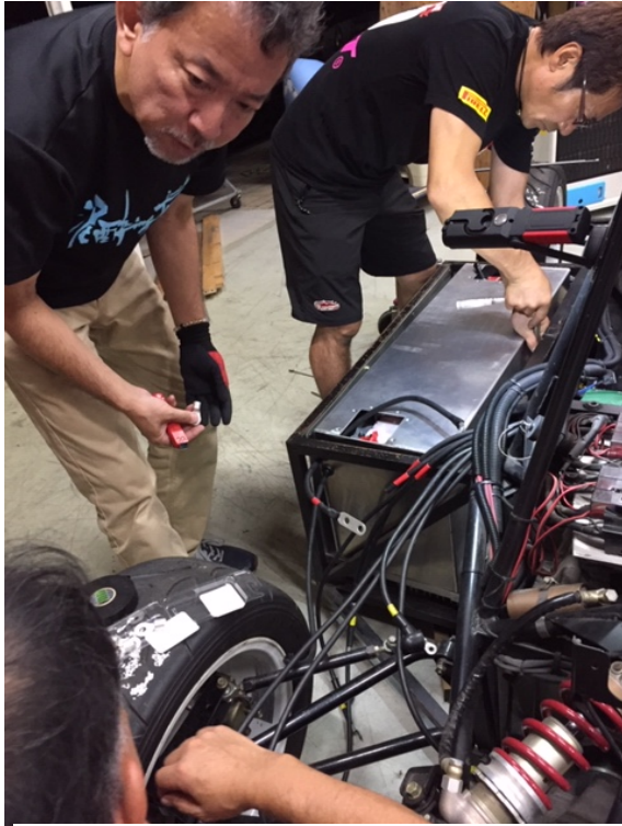
電池ケースの取り付け。
